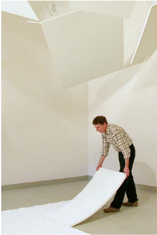
Messung des Absorptionsgrades im Hallraum
