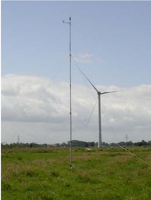
Mast zur Aufnahme meteorologischer Daten
